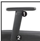
**2F-Armlehnen:** Höhenverstellbar (10 cm; Taste ① drücken) und werkzeuglos breitenverstellbar (2,5 cm; Exzenterverschluss ② öffnen – Armlehne in gewünschte Position schieben – Exzenterverschluss schließen).
