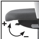
**Arretierung des Rückenlehnenneigungswinkels** (in vorderster Sitzposition): Rückenlehne entlasten, Hebel nach unten drücken bis zur Arretierung. Lösen: Rückenlehne entlasten, Hebel nach oben ziehen.
