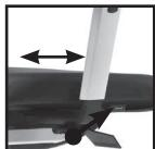
**Sitztiefenverstellung (5 cm):** Taste drücken und die Sitzfläche nach vorn führen, Taste zur Arretierung loslassen. Rückführung in die Grundposition: Sitz entlasten, Taste drücken, Sitzfläche nach hinten führen, Taste zur Arretierung loslassen.
