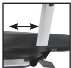
**Réglage de la profondeur d'assise (5 cm):** Tirer la touche et amener la surface d'assise vers l'avant; Pour verrouiller, lâcher la touche. Retour automatique en position initiale: Relâcher la pression sur l'assise, extraire la touche.
