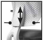
**Schiene regolabili in altezza** (sistema Easy-Touch, 8 cm): Sollevare con entrambe le mani lo schienale portandolo nella posizione desiderata in maniera graduale. Per abbassare lo schienale, portarlo nella posizione più alta, abbassarlo completamente ed eventualmente sollevarlo ancora in maniera graduale.
