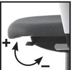
**Verrouillage de l'angle d'inclinaison du dossier** (dans la position la plus avancée): délester le dossier, pousser le levier vers le bas jusqu'au verrouillage. **Déverrouillage:** délester le dossier, pousser le levier vers le haut.
