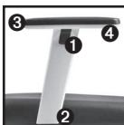
**4F-Armlehnen:** Höhenverstellbar (10 cm; Taste ① drücken), werkzeuglos breitenverstellbar (2,5 cm; Exzenterverschluss ② öffnen – Armlehne in gewünschte Position schieben – Exzenterverschluss schließen), tiefenverstellbar ③ (4 cm; Pad nach vorn oder hinten führen). Beidseitig schwenkbar um 30° ④.
